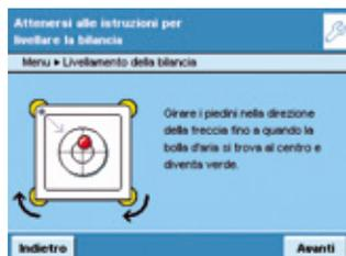
Q-Level combina una sensorica appena sviluppata con la più moderna tecnologia di visualizzazione rendendo così il livellamento della bilancia facile, veloce e sicuro. Con le unità di visualizzazione e comando MSA e MSU viene fornito di serie il livellamento manuale interattivo. In tal modo il display mostra tutte le informazioni necessarie. Posizione della livella e indicazioni della
