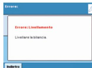
Cubis® offre funzioni di promemoria e allarme con gerarchia delle azioni fissa per livellamento, peso minimo e calibrazione | regolazione.
