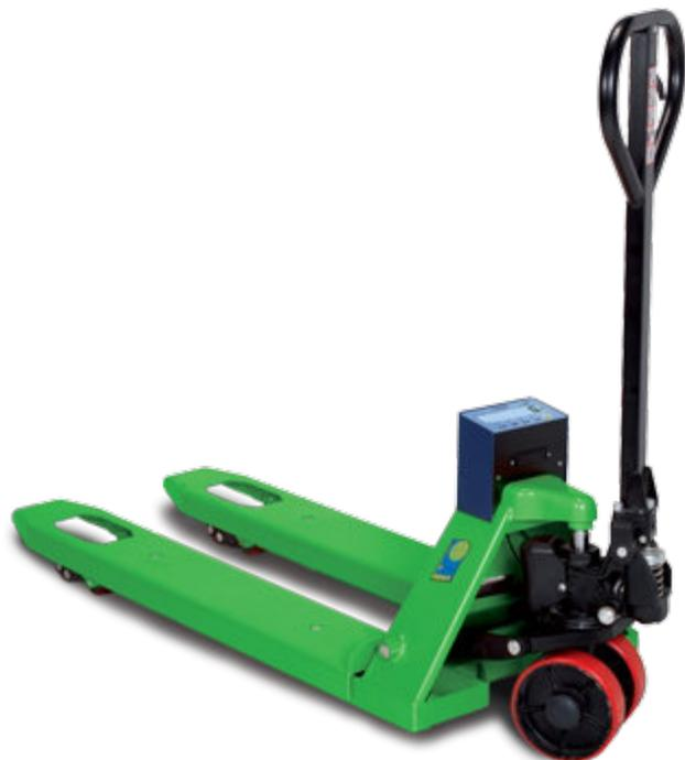
Transpallet maneggevole e facile da utilizzare. Il nostro transpallet con bilancia elettronica è dotato di 4 celle di carico tipo shear-beam, che permettono di ottenere maggiore precisione di pesatura, e di indicatore di peso multifunzione, con grande display retroilluminato per permettere la lettura ottimale del peso anche in condizioni di scarsa illuminazione.
